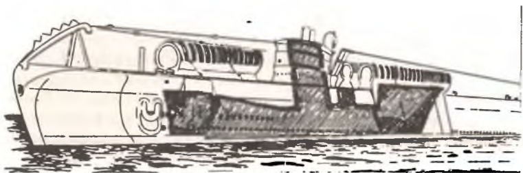
Подводная лодка «Ширé» после переоборудования в целях транспортировки управляемых торпед
