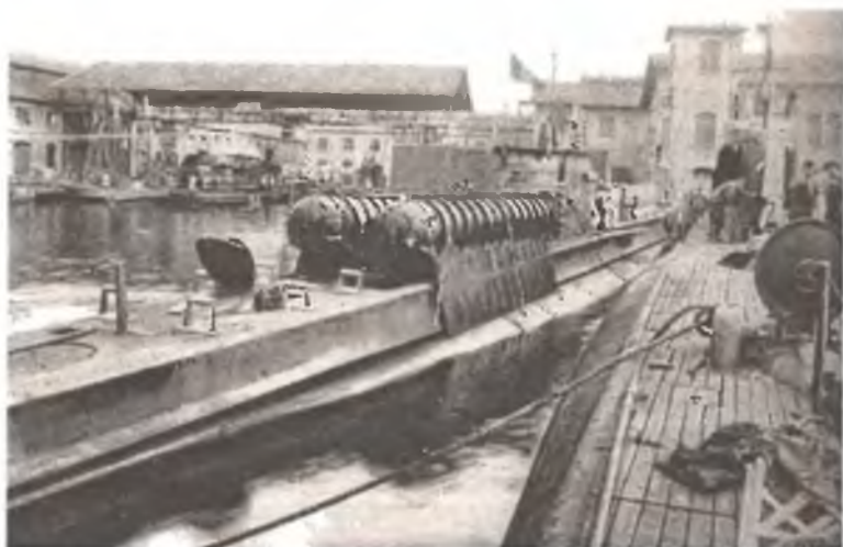
Подводная лодка «Ширé» с контейнерами для торпед SLC
